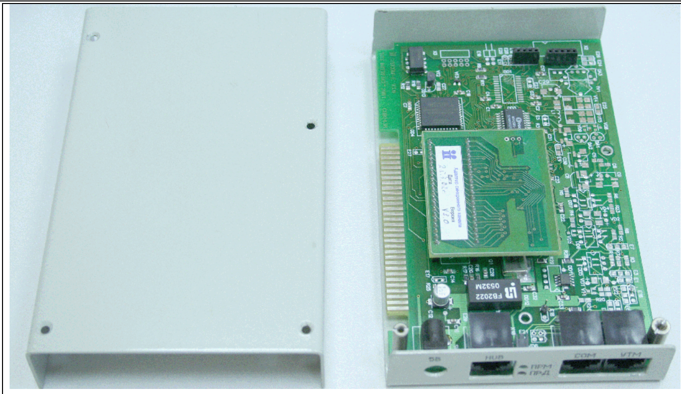
Рис. 1. Контроллер “Синком-Е” в отдельном корпусе. Вид со снятой крышкой. Внешний вид группы контроллеров, установленных в крейт 3U, приведен на рис. 2.
