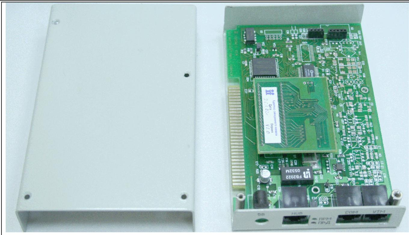
Рис. 1. Контроллер “Синком-Е” в отдельном корпусе. Вид со снятой крышкой.
