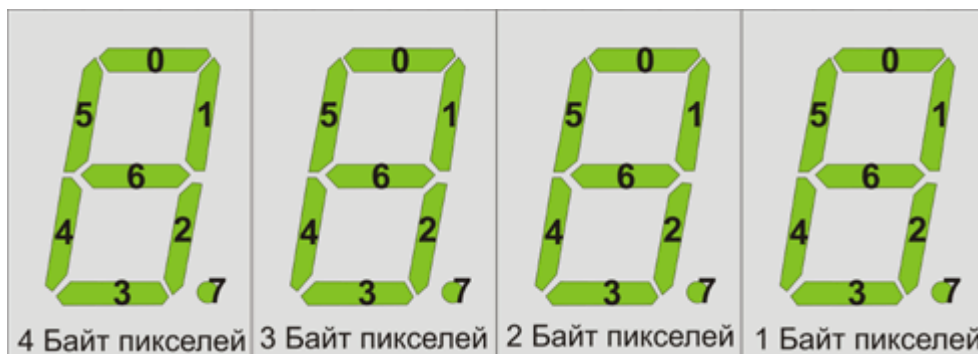
Схема раскладки битов (0-младший) по сегментам индикаторов
