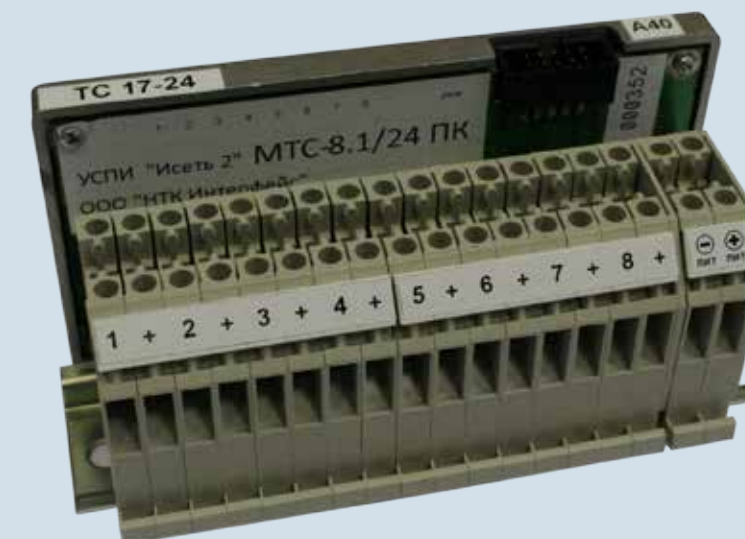
Модуль ввода дискретных сигналов «МТС-8.1/24 ПК» (проходные клеммы)
