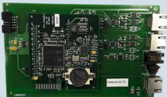
Внешний вид контроллера «Синком-Д/ЗУ»
