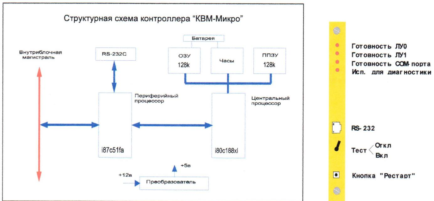
Микропроцессорный контроллер внутриблочной магистрали КП "Гранита" - "КВМ-Микро" выполнен в виде одноплатного модуля. Он устанавливается вместо модуля КВМ-2 (КС-59-10.2) и поддерживает независимый прием и передачу данных через два линейных узла КП, а также через порт RS-232 для связи контроллера с ПЭВМ. Контроллер поддерживает типовой протокол обмена с КП в полном объеме.
